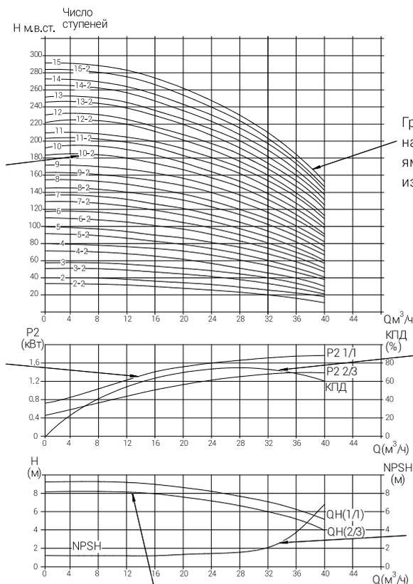
График характеристики QH соответствующего насоса. Графики, указанные выделенными линиями, показывают рекомендуемую область производительности с оптимальным КПД.
