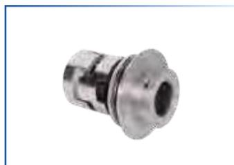
Торцевое уплотнение картриджного типа предназначено для герметизации вала. Торцевое уплотнение позволяет выдерживать высокие тепловые нагрузки, обеспечивает длительный срок службы, простоту замены. Корпус торцевого уплотнения выполнен из нержавеющей стали. Трущиеся детали выполнены из металлокерамических материалов, статические части выполнены из фторкаучука.
